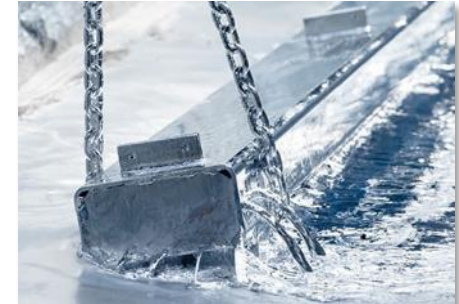
ZINQ GmbH & CO KG Feuerverzinkung (ca. 450°C)
