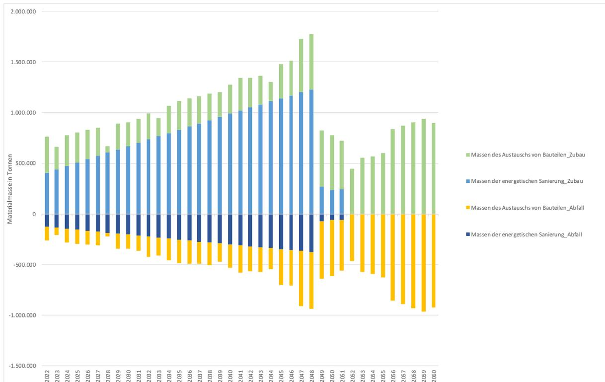
Abbildung 21: Gemeinsame Betrachtung von Massen der energetischen Sanierung und des Austauschs von Bauteilen innerhalb des 4%-Szenarios
