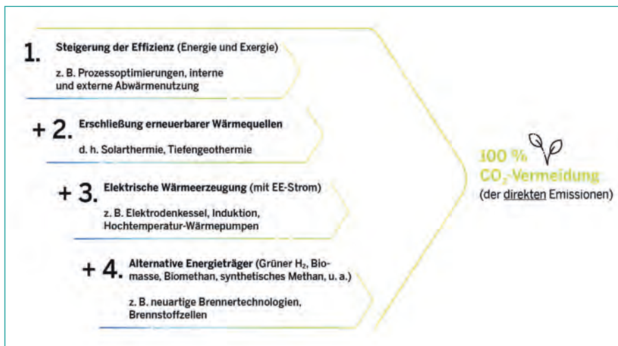
Abb. 2 4-Stufen-Modell zur Dekarbonisierung industrieller Prozesswärme
